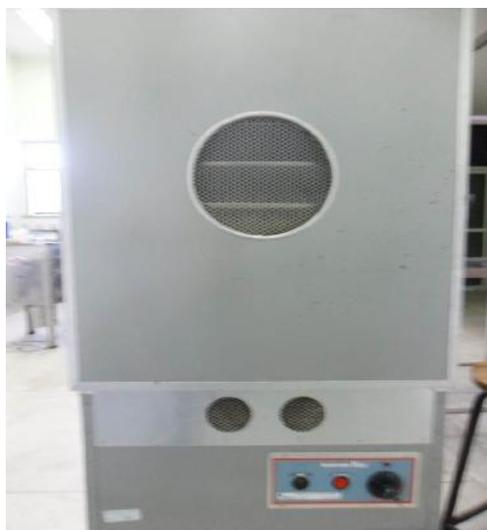
**Figura1.** Secador de fluxo contínuo
