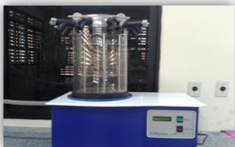
Figura 1. Liofilizador de bancada do Laboratório de Processos Químicos da Univasf/campus de Juazeiro.
