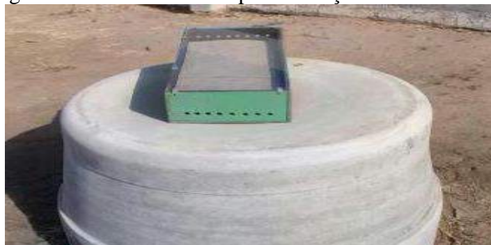
Figura 5: Secagem em dessecador solar para obtenção da fitomassa seca e pesagem.
