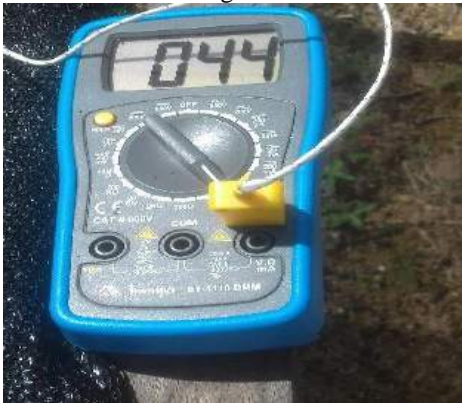
Figura 2: Multímetro digital no modo termômetro.
