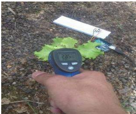
Figura 3: Medidas utilizando o Arduino e o termômetro infravermelho.
