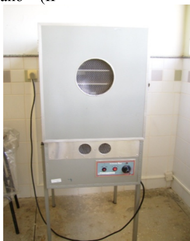
Figura 2. Secador elétrico com circulação de ar forçado.
